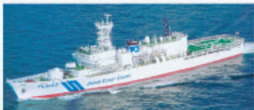
ヘリ搭載型巡視船 総トン数 3,111t 全長 105.4m × 幅 14.6m × 深 8 m
