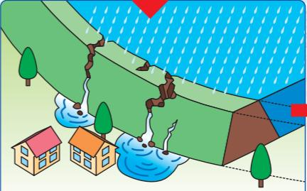
大雨による増水、大地震等で堤に亀裂、漏水が発生!
