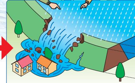
破損した堤が貯水に耐えきれず決壊!
