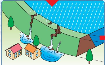
大雨による増水、大地震等で堤に亀裂、漏水が発生!
