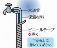
水道管の凍結を防ぐには、保温材(古い毛布や発泡スチロールなど)を巻き付け、その上からビニールテープなどを巻いて固定します。また、専用の保温チューブもホームセンターなどで市販されています。
